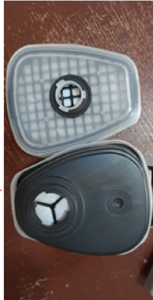
IMPORTANTE NO REALIZAR COMBINACIONES DE MARCAS YA QUE ESTOS NO ACOPLAN CORRECTAMENTE E INTERFIERE EN EL FUNCIONAMIENTO
