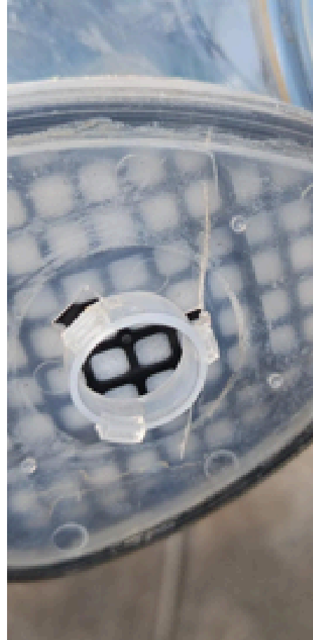
ADPTADOR FISURADO POR TROPIEZO DURANTE LA LABOR
