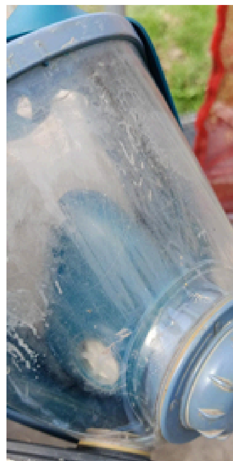
VISOR RAYADO SIN PROTECTOR – SIN ASEO – Y APLICA JABON EN EXCESO DURANTE EL USO
