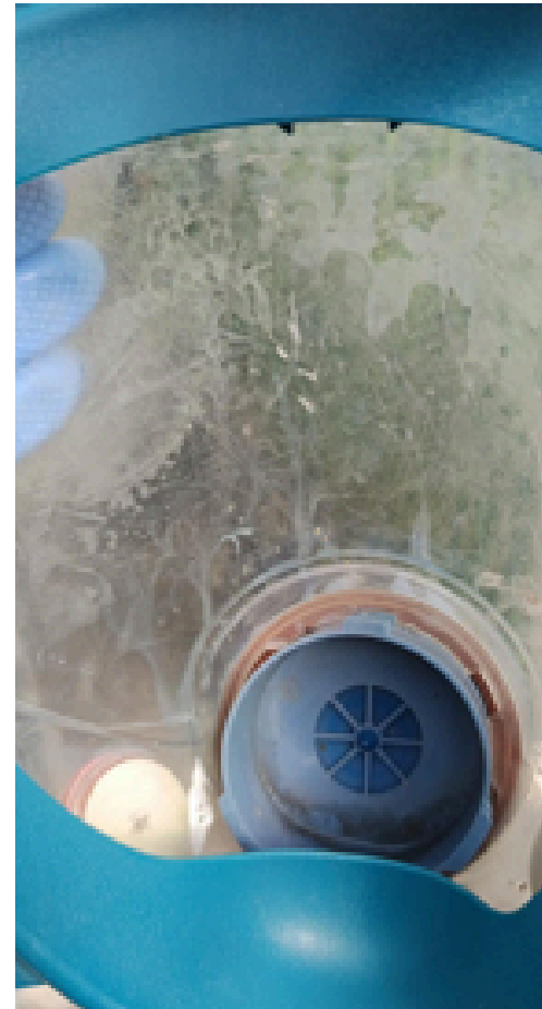
VISOR RAYADO SIN PROTECTOR – SIN ASEO – Y APLICA JABON EN EXCESO DURANTE EL USO
