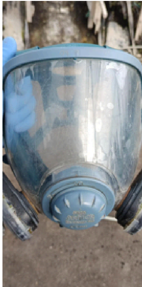
PROTECTORES DE VISOR CON DESGASE Y REALIZAR CAMBIO
