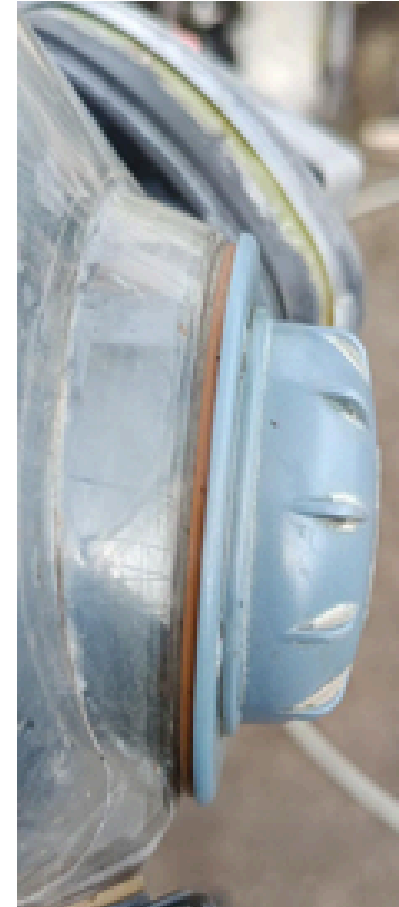
IMPORTANTE REALIZAR ASEO DIARIO DEL RESPIRADOR, SE ENCUENTRAN RESIDUOS ACUMULADOS
