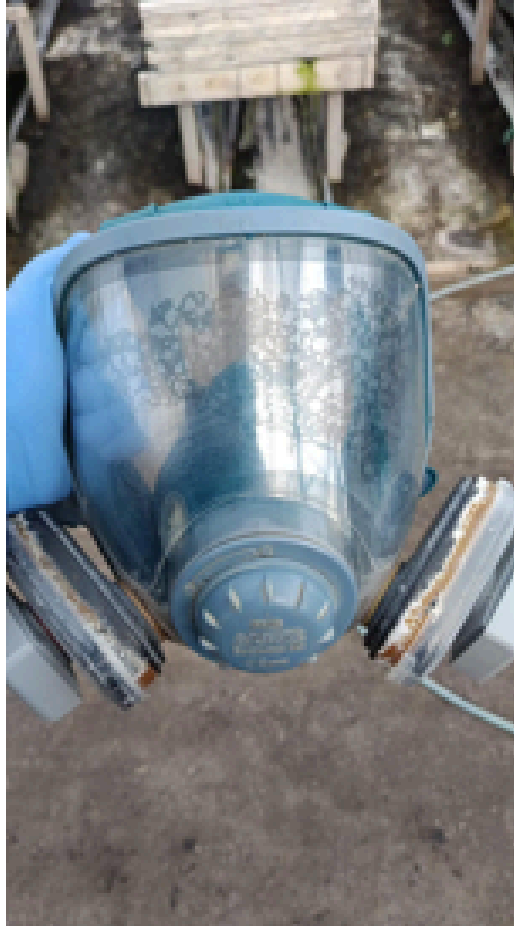
PROTECTORES DE VISOR CON DESGASE Y REALIZAR CAMBIO
