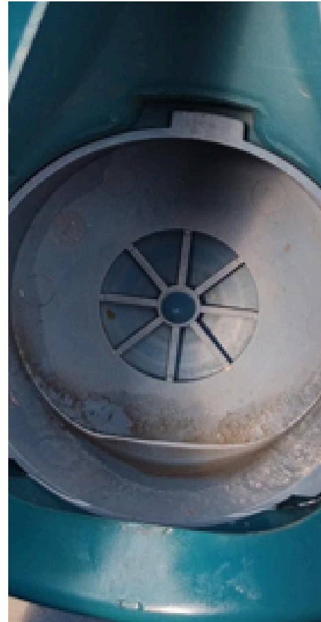
IMPORTANTE REALIZAR ASEO DIARIO DEL RESPIRADOR, SE ENCUENTRAN RESIDUOS ACUMULADOS
