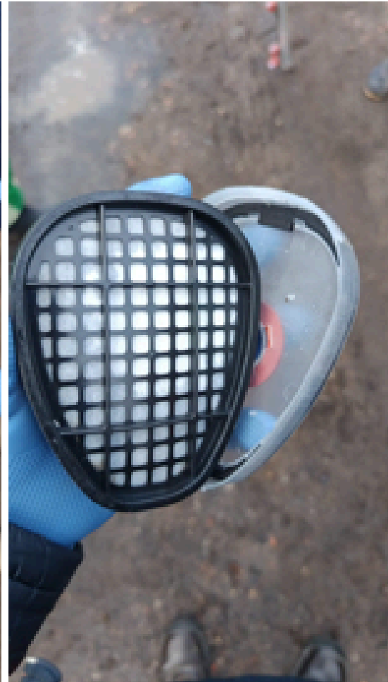
CARTUCHOS HUMEDOS POR FALTA DE AJUSTE DE ADAPTADORES – REALIZAR CAMBIO
