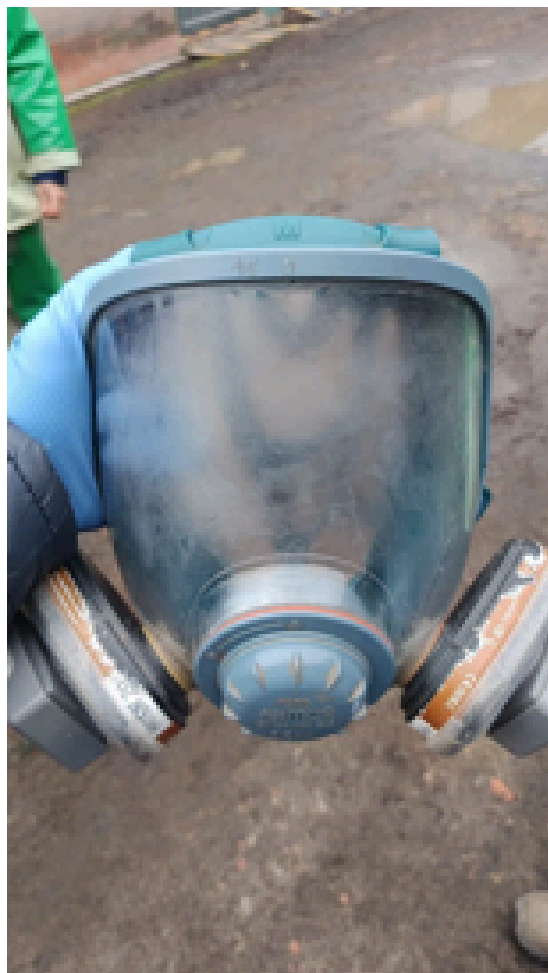
VISOR RAYADO POR FALTA DE PROTECTOR Y CUIDADOS AL INTERIOR
