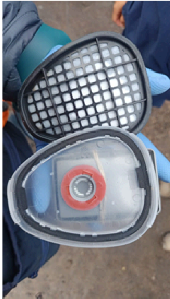
CARTUCHOS HUMEDOS POR FALTA DE AJUSTE DE ADAPTADORES – REALIZAR CAMBIO
