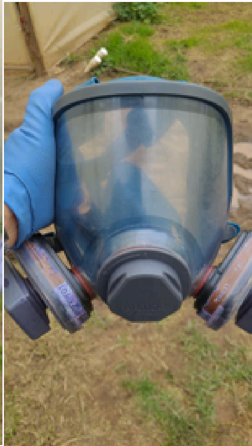
PROTECTOR CON PRESENCIA DE DESGASTE – PROXIMOS CAMBIOS
