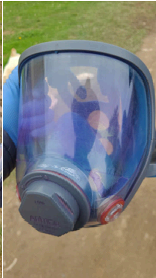
VISOR EN BUEN ESTADO – SIN PROTECTOR – IMPORTANTE INSTALAR
